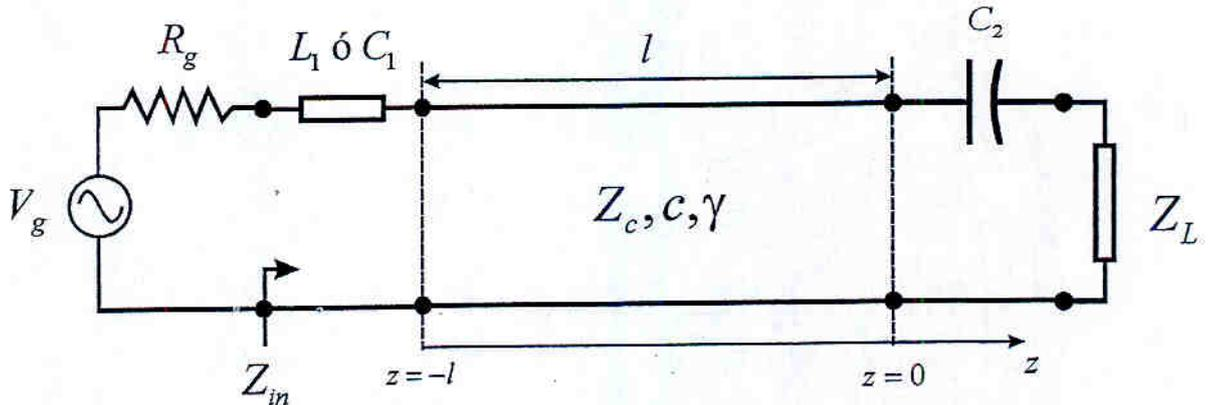
Figura 1. Circuito de adaptación en régimen permanente sinusoidal.
