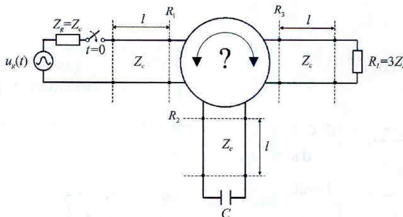
**Figura 2.** Circuito bajo análisis con circulator y líneas de transmisión coplanares.
