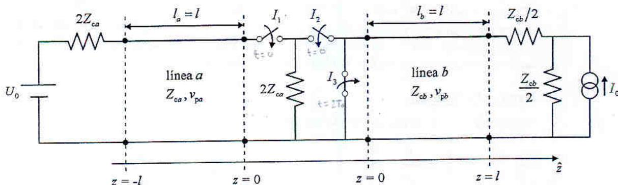
**Figura 1.** Circuito del que se pretende analizar su comportamiento en régimen transitorio.
