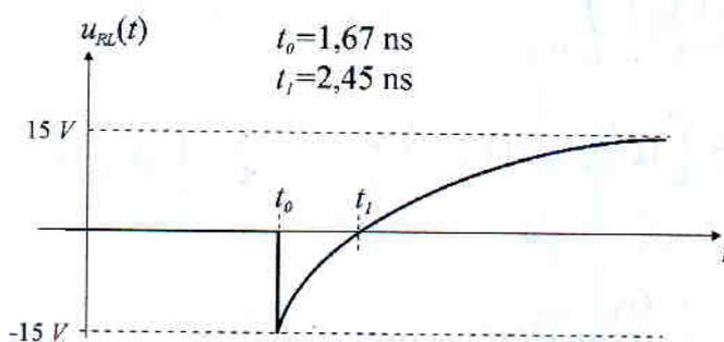
Figura 3. Evolución temporal de la tensión en bornes de la resistencia de carga  $R_L$ .
