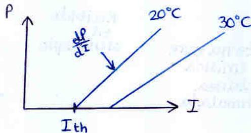
Variación corriente umbral con temp:  $I_{th}(T) = I_0 \cdot e^{\frac{T}{T_0}}$
