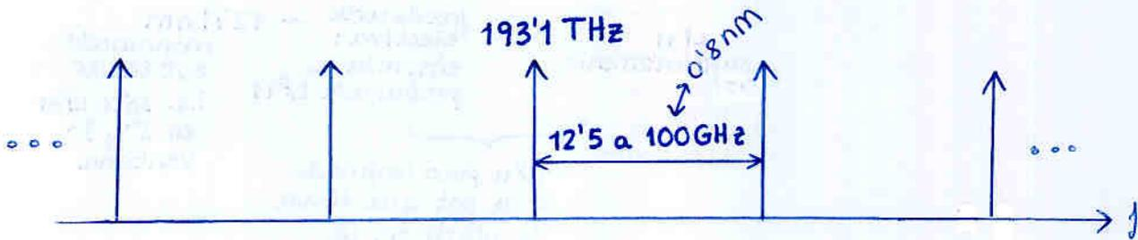
El WDM tiene sus salidas 'sintonizadas' a cada canal
