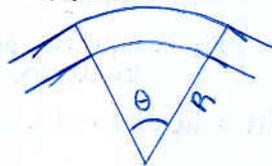
se evitan respetando el mínimo radio de curvatura dado por el fabricante
